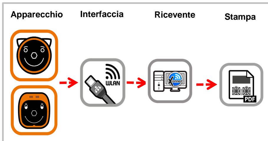
Figura 4: Accesso automatico alla rete tramite "plusoptiXconnect"
